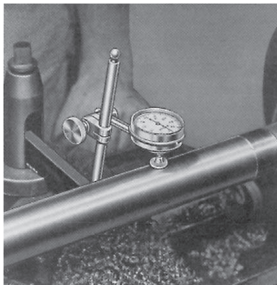
Para una verificación rápida de excentricidad, el tornero usa el reloj comparador universal montado en un portaherramientas.
