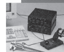
N° 761 conectado al micrómetro 733MXFL-25 y calibre 797B-6/150.
