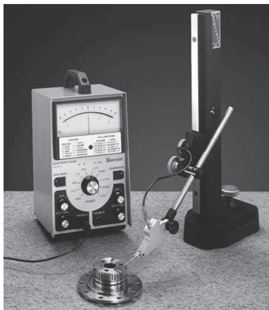
Indicador Electrónico N° 717 con Calibrador de Altura N° 252 y Palpador N° 715-1Z.
