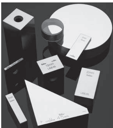
Los bloques patrón son usados em cualquier industria como patrón básico y tienen exactitud de centésimas de micrón o millonésimas de pulgadas.
