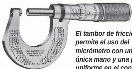
La carraca de un micrómetro garantiza una presión de medición constante.
