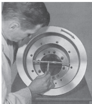
Verificando el diámetro interno de un agujero profundo con un micrómetro de interiores. Un mango muy práctico está sujeto en el centro del micrómetro.
