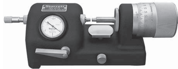
Micrómetro de Banco STARRETT.
