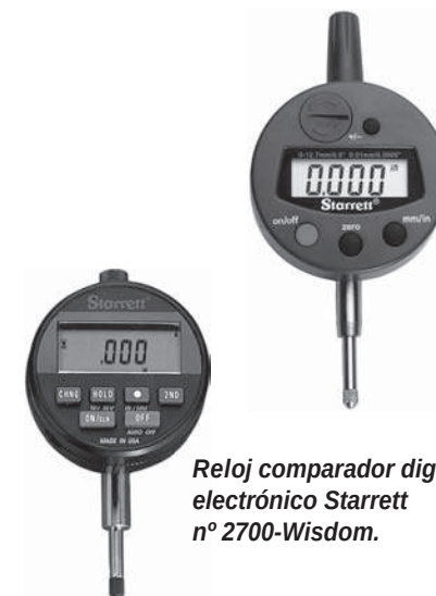
Reloj comparador digital electrónico Starrett n° 3600.
