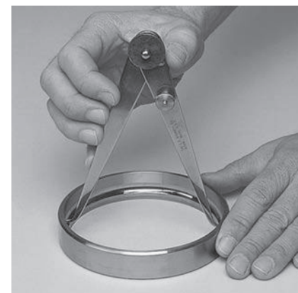
Cuando instrumentos de medición sin graduación se sujetan levemente por los dedos, es posible sentir diferencias ín mas de medidas.
