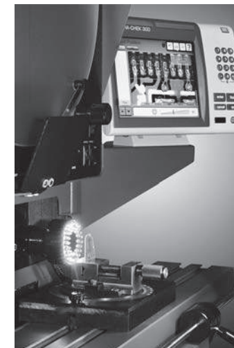
Adaptador de video OV 2 combinado con el Quadra- Chek QC300 utilizando capacidades grá cas.
